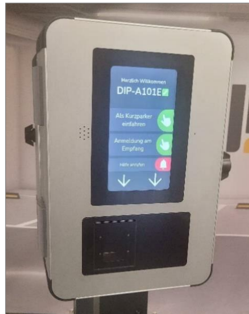
Abbildung 20 - links: Manuelle Eingabe des KFZ-Kennzeichens am Terminal, wenn Kennzeichen nicht richtig erkannt wurde oder beschädigt ist bzw. falls anderes Fahrzeug genutzt wird (Quelle: dipano)
