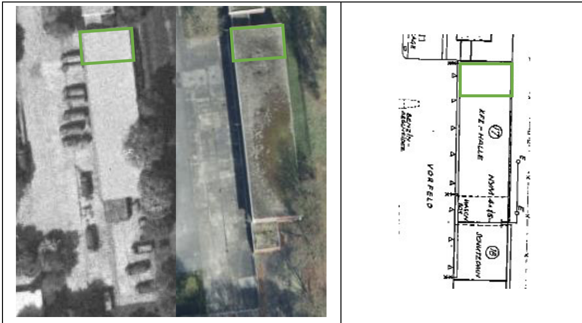
Abbildung 10: Ausschnitt aus dem Luftbild 1961 und 2018 und aus dem Lageplan von 2002 (rechts) mit Kennzeichnung der Waschhalle mit Wartungsgrube (grün)
