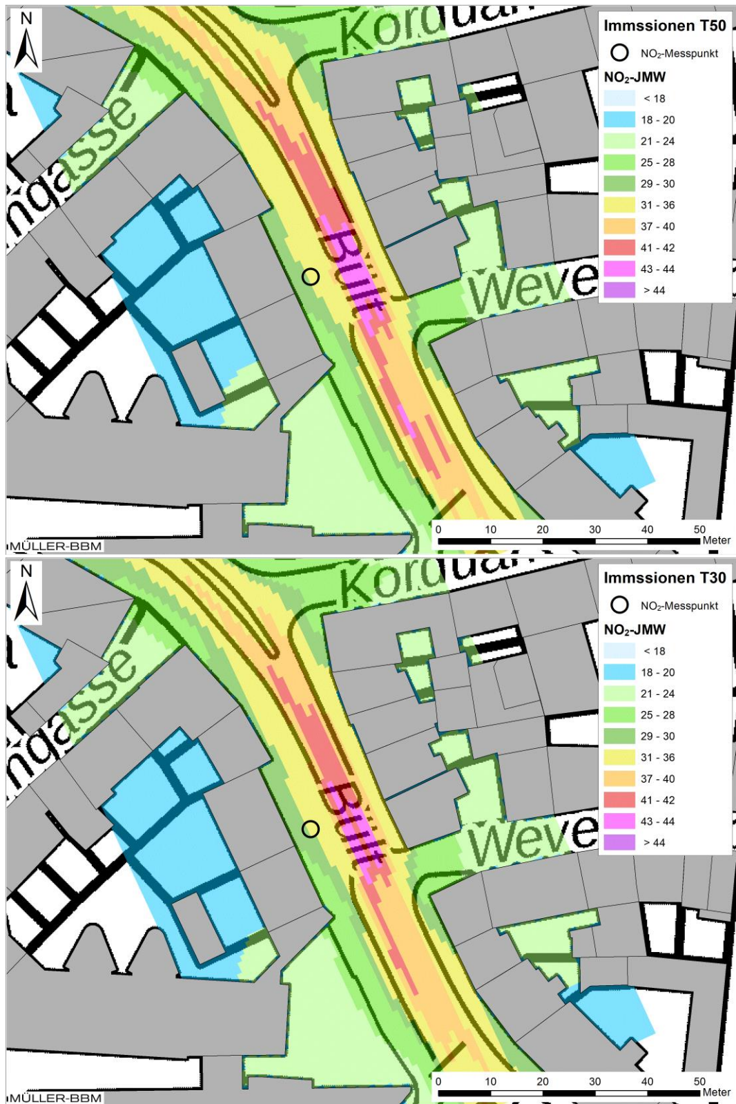
Abbildung 7. Straßenquerschnitt Bült – NO 2 -Immissionen (Jahresmittelwerte) bodennah für Tempo 50 oben und Tempo 30 unten [6], [19].
